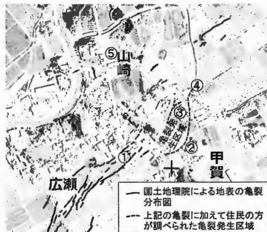
図 1 国土地理院で調べられた狩尾地区の亀裂分布に住民の方が調べられた亀裂を加筆した図
